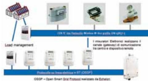
Collegamento del contatore elettrico con altri misuratori tramite moduli M-Bus Wireless o con M-Bus cablato. Nel secondo caso si eviteranno le alimentazioni a batteria nei contatori acqua e gas.
